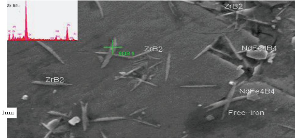
الشكل (5) صورة بواسطة الإلكترون الثانوي للسبيكة Nd_{12.68}Fe_{77.91}B_{8.41}Zr_1 تبين انتشار طور ZrB_2 الابري في السبيكة .
