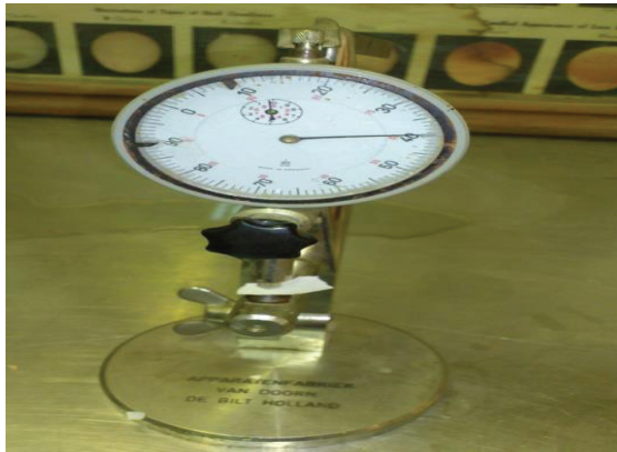
الشكل (2) جهاز الميكروميتر المستخدم لقياس سمك القشرة بيض هذه الدراسة
